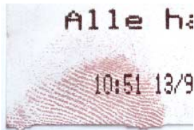
Detail einer Wartenummer, entwickelt mit ThermaNin in Petrolether.
