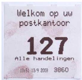
Wartenummer, entwickelt mit ThermaNin in Petroleumether
